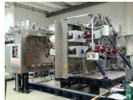
フレキシブル有機EL照明用成膜装置
